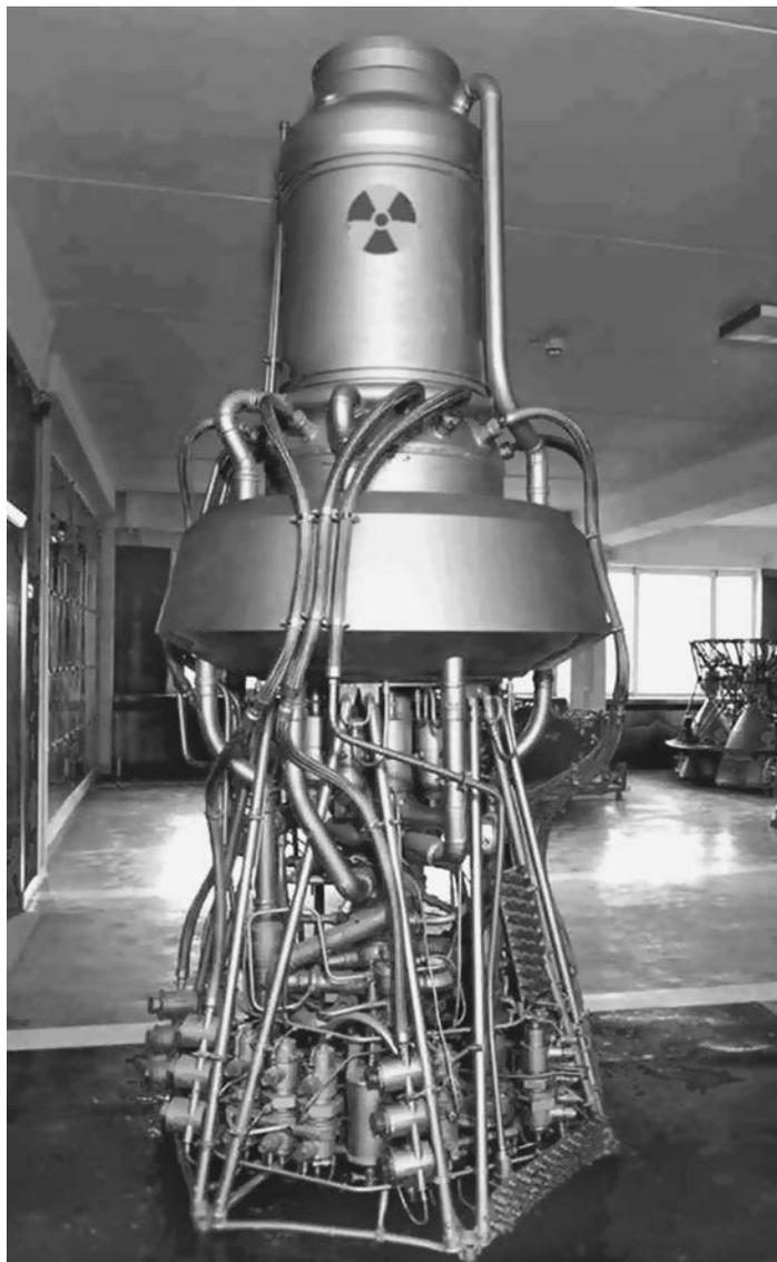
*Ядерный ракетный двигатель РД-0410, созданный под руководством В.М. Иевлева. Энергетический пуск первого реактора ЯРД прошел в 1978 г.*
